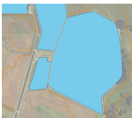
Rys. 5. Przykład prawidłowego poprowadzenia poziomic dla stojącej wody powierzchniowej lub zbiornika technicznego przedzielonych obiektem „wał przeciwpowodziowy lub grobla”.
